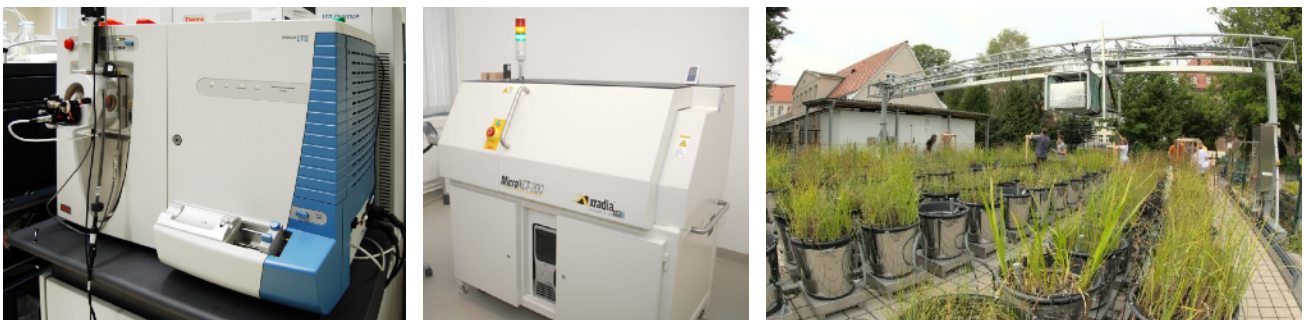
Abb. 3 | Einblick in die Forschungsinfrastruktur: Massenspektrometer für Proteomanalysen (rechts), Micro-Computertomograph für die zerstörungsfreie Untersuchung von Organismen (Mitte) und vollautomatisierte Mesokosmenanlage für die Analyse von Pflanzenwuchs und -vitalität sowie Wasserverbrauch (links).
