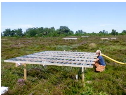
Durch diese Versuchsanlage wird überprüft, wie sich eine Reduzierung des Niederschlages auf die Heidevegetation auswirkt. – Foto: Jürgen Kreyling
